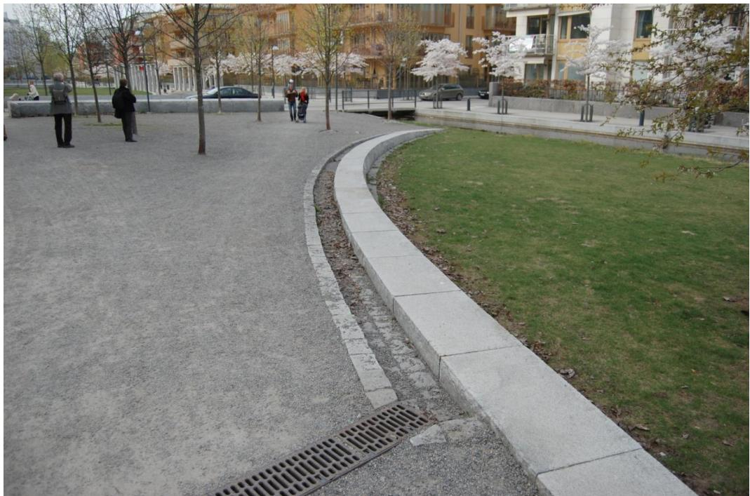
Foto 4: Dažďová voda za pomoci podzemného a otvoreného systému odvádzania sa vlieva do umelo vytvoreného retenčného vodného kanálu, Stockholm, Švédsko (archív autorky)
